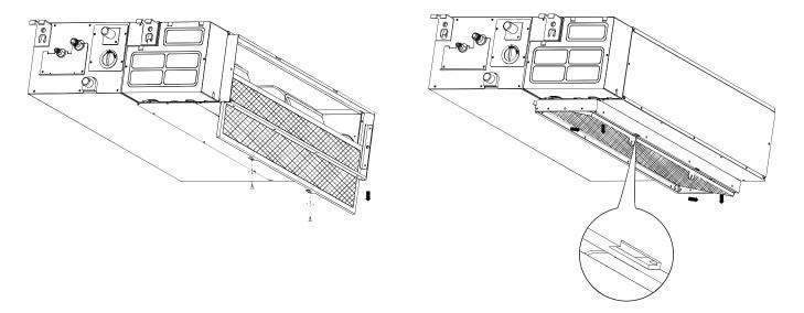
2. Смывайте грязь с сетки фильтра с помощью мягкого моющего средства, тряпки и воды до тех пор, пока визуально вы не увидите не одной пылинки.
