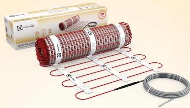
Самоклеющийся **Easy Fix Mat** имеет тонкий нагревательный кабель Ø3,5 мм, вплетенный в самоклеющуюся текстильную основу. Рекомендуется для укладки в тонкий слой плиточного клея «без стяжки» с минимальным подъемом уровня пола.
