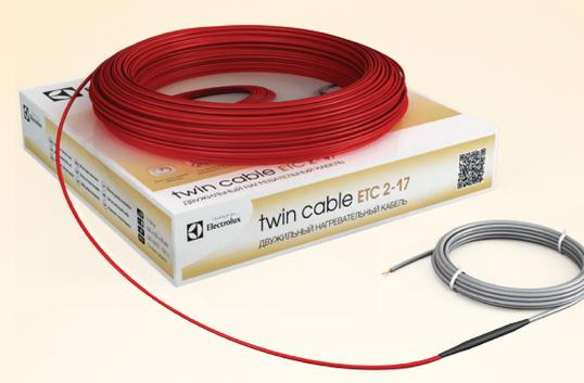
Двухжильный **Twin Cable** для укладки в бетонную стяжку не менее 3 см. Подходит для помещений любой конфигурации. Применяется как для комфортного 150 Вт/м<sup>2</sup> с шагом укладки 11,5 см, так и основного 200 Вт/м<sup>2</sup> с шагом укладки 8,5 см обогрева помещений.
