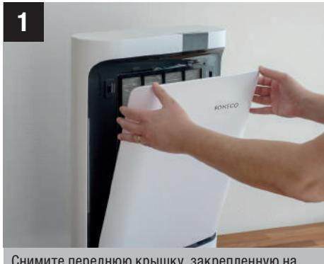
Снимите переднюю крышку, закрепленную на магнитных держателях.
