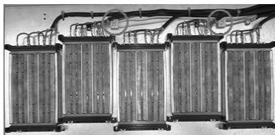
Внешний вид нагревательных элементов. Термомоконтакты обведены на фотографии.
