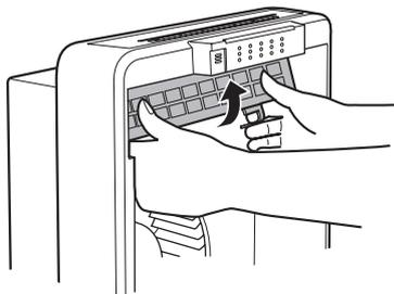
**4** Замочите и промойте катализатор и угольный фильтр.
