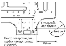
1. После определения положения отверстия для трубки на установочной пластине (➡), просверлите отверстие для трубки (Ø65 мм) с небольшим наклоном в сторону наружного блока.
