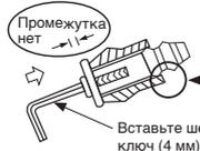
Не применяйте масло (охлаждающее машинное масло) при установке дренажного колпачка. Применение вызывает ухудшение состояния и утечку воды через пробку.
