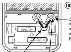
Затяните надежно, но при этом момент затяжки не должен превышать 0,25 Н·м (0,03 кгс·м)
