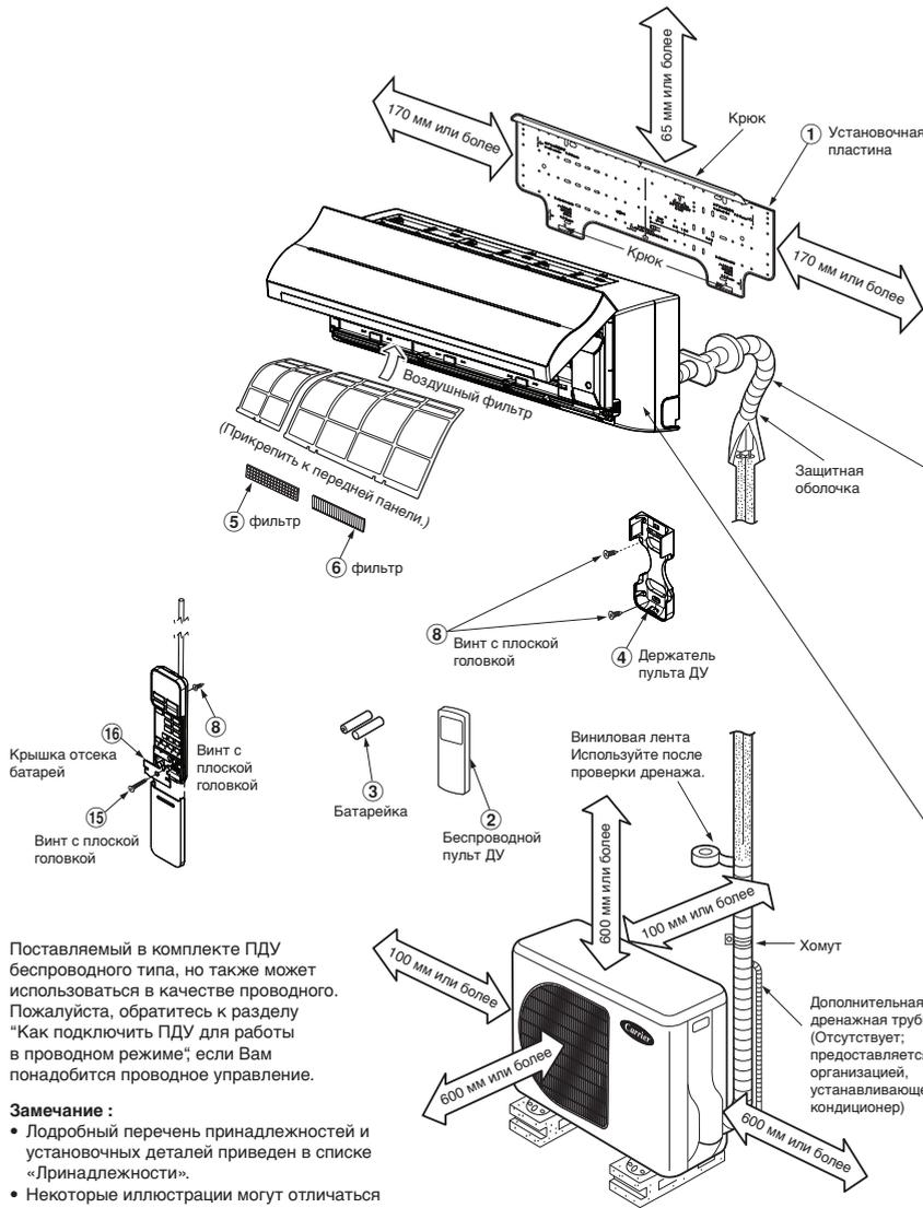
Поставляемый в комплекте ПДУ беспроводного типа, но также может использоваться в качестве проводного. Пожалуйста, обратитесь к разделу «Как подключить ПДУ для работы в проводном режиме» если Вам понадобится проводное управление.
