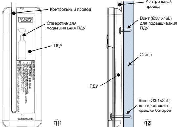
Затяните надежно, но при этом момент затяжки не должен превышать 0,15 Н·м (0,02 кгс·м)
