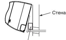
Вставьте подушечку между внутренним блоком и стеной и наклоните внутренний блок для обеспечения лучшей работы.
