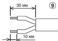
\* Сечение провода 28-22 AWG или 0,08-0,32 мм<sup>2</sup>
