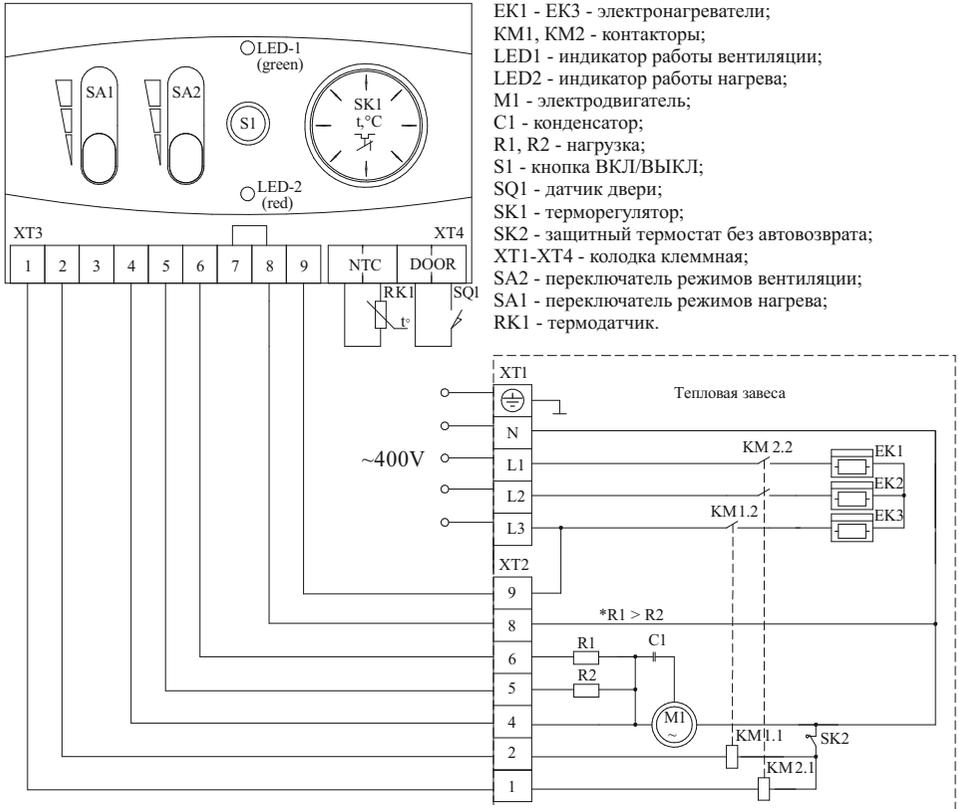
**Рисунок 20. Подключение завес KVC-B10E6-01 и KVC-B15E6-01 к однофазной сети**
