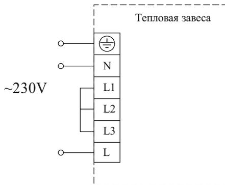
**Рисунок 20. Принципиальная схема группового подключения завес к одному контроллеру KRC-32**
