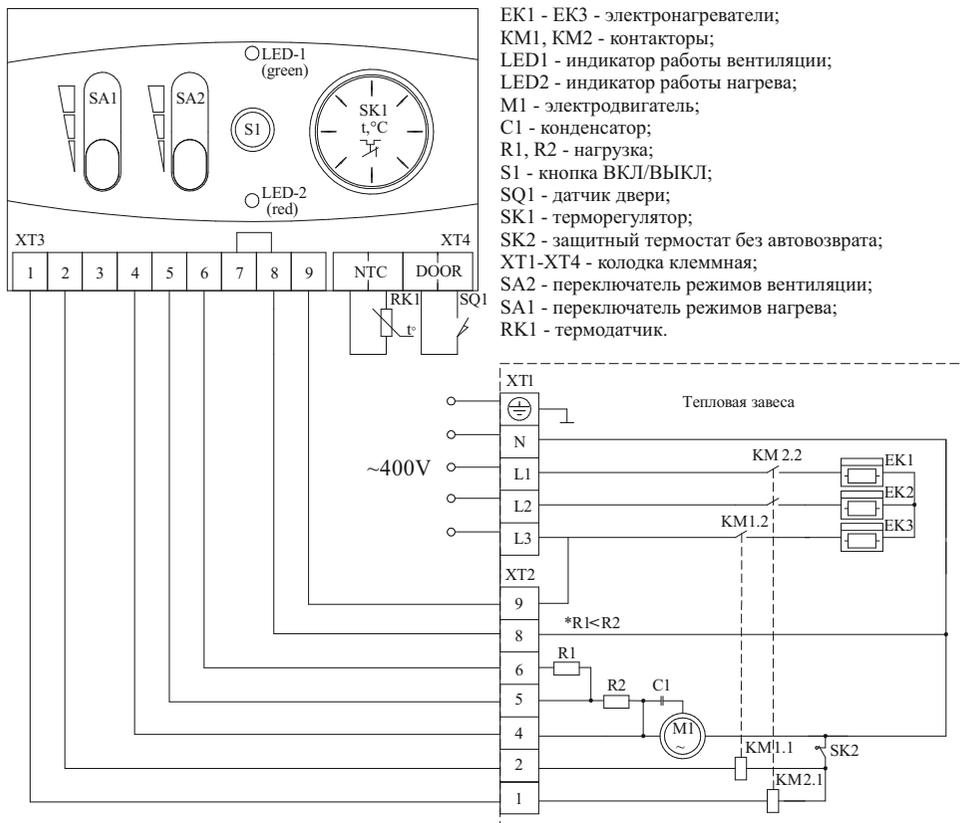
**Рисунок 18. Принципиальная схема подключения завесы KVC-B15E6-01 к контроллеру KRC-32**
