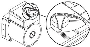
В котле предусмотрена функция «анти-блокировки» насоса. При выключенном котле, насос включается на 3 минуты, через каждые 24 часа. Но данная функция работает только в том случае, если котел подключен к электричеству.
