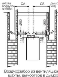
Воздухозабор из вентиляционной шахты, дымоотвод в дымоход
