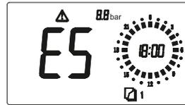
Давление в контуре системы отопления опустилось более 2,8 бар. При увеличении давления более 2,8 бар, на дисплее отображается ошибка E5 и звучит звуковой сигнал. После снижения давления менее критического давления нажав кнопку «RESET» котел перезапустится.
