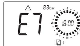
Датчик температуры теплоносителя неисправен.
