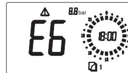
Датчик температуры горячего водоснабжения неисправен.
