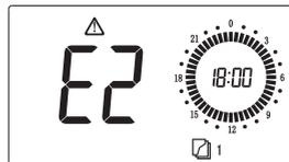
Температура теплоносителя более 100°C.
