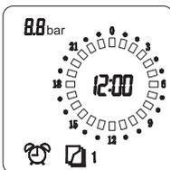
На табло все метки выключены (OF) и котел работает в режиме отопления с температурой теплоносителя на 20°C меньше заявленной.
