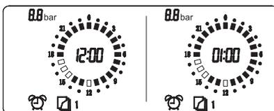
На табло высвечивается программа на 1 день недели. Температура теплоносителя равна заданному значению с 0 часов до 11 часов, с 13 часов до 15 часов и с 18 часов до 24 часов. Остальное время температура теплоносителя на 20 градусов ниже.
